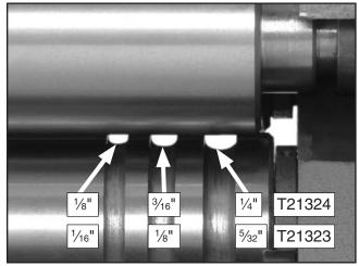
Figure 29. Wire grooves.
